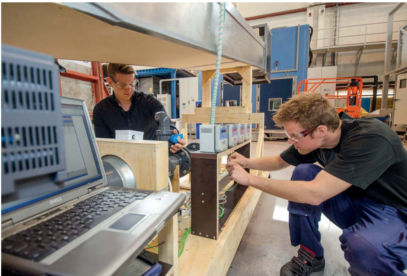
TAR TAK. Masterstudent Espen Hansen (til venstre) og PhD-kandidat Lars Gullbrekken forsker på luftstrømninger i skrå tretak.
